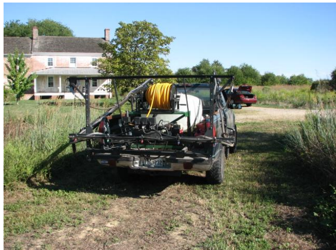
Figure 3. Dispositif installé sur une camionnette et permettant l'épandage d'herbicides pour contrôler le roseau commun dans les marais saumâtres de la région de Washington (photographie : C. Lavoie).
