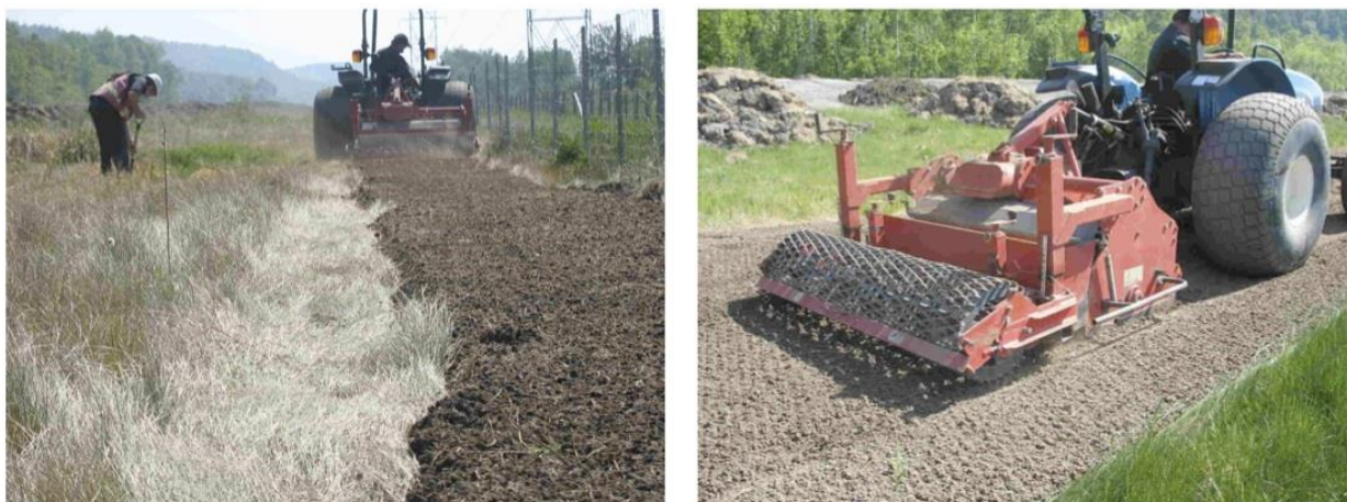
Figure 15 : Préparation du sol à l'aide d'un motoculteur de type «Rotadairon» suite au traitement herbicide de la zone de plantation (Site Fassett; photographie : P. Boivin).
