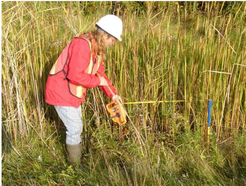
*Figure 2. Mesure de la progression spatiale annuelle d'une population de roseau commun le long d'un fossé de drainage autoroutier, un jalon de bois posé au cours de l'automne précédent servant de repère (photographie : Y. Jodoin).*
